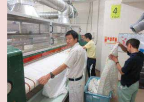
シーツローラーを使用して作業
